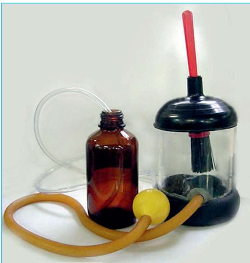
Figura 41. Perifitômetro com escova -VIS, 1997, modificado (Foto: Rita Cerqueira Ribeiro de Souza/CETESB).
