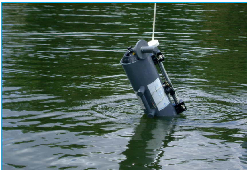
Figura 62. Coleta de amostra em profundidade com garrafa de van Dorn de Fluxo Vertical (Foto: Carlos Jesus Brandão/CETESB).
