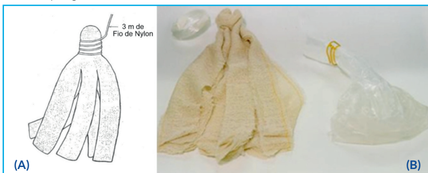
Figura 7. Mecha empregada na técnica de Moore: (A) Esquema; (B) foto da mecha de gase com meio de transporte (Carry Blair) (Foto: Carlos Jesus Brandão/CETESB).
