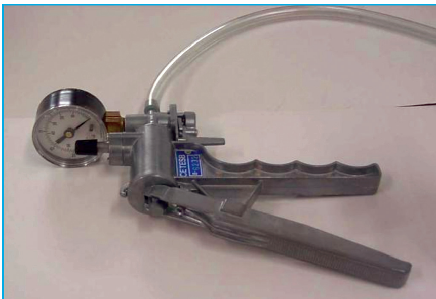
Figura 70. Bomba de Vácuo Manual para campo (Foto: Carlos Jesus Brandão/CETESB).
