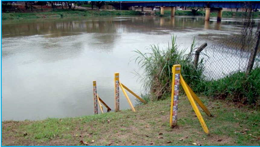
Figura 91. Réguas Limnimétricas (Foto: Luis Altivo Carvalho Alvim/CETESB).
