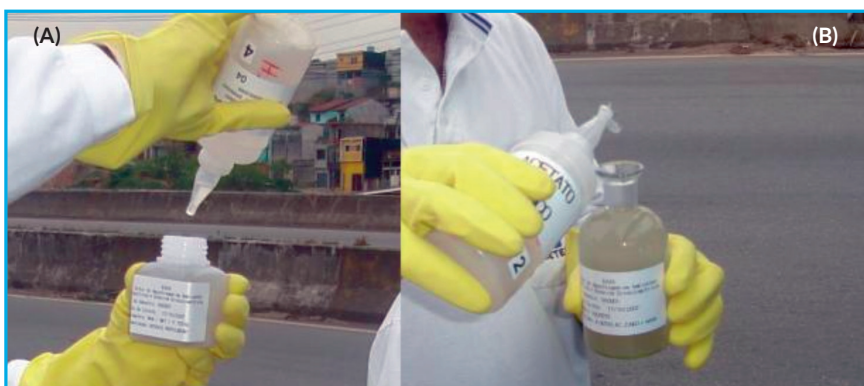
Figura 61. Procedimento de preservação de amostra: (A) Adição de ácido nítrico 1+1 para preservação de metais pesados; (B) Adição de acetato de zinco para preservação de sulfeto (Fotos: Carlos Jesus Brandão/CETESB).
