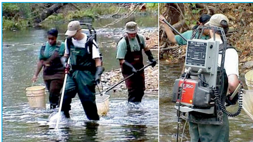
Figura 57. Pesca elétrica com aparelhagem do tipo móvel (mochila). Foto: American Fisheries Society (usado com permissão)
