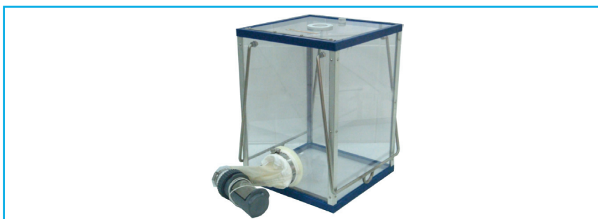
Figura 17. Armadilha de Schindler-Patalas (Foto: Carlos Jesus Brandão/CETESB).
