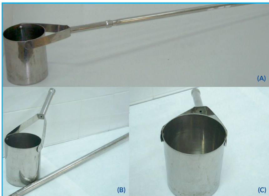
Figura 10. Coletor com braço retrátil: (A) Vista lateral do equipamento montado; (B) Vista do balde e do braço retrátil desmontado; (C) Vista superior do balde coletor (Fotos: Carlos Jesus Brandão/CETESB).
