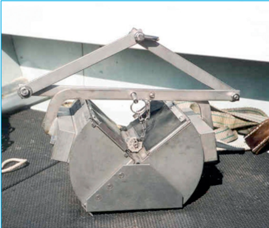
Figura 25. Pegador Ponar Pequeno (Foto: Mônica L. Kuhlmann/CETESB).
