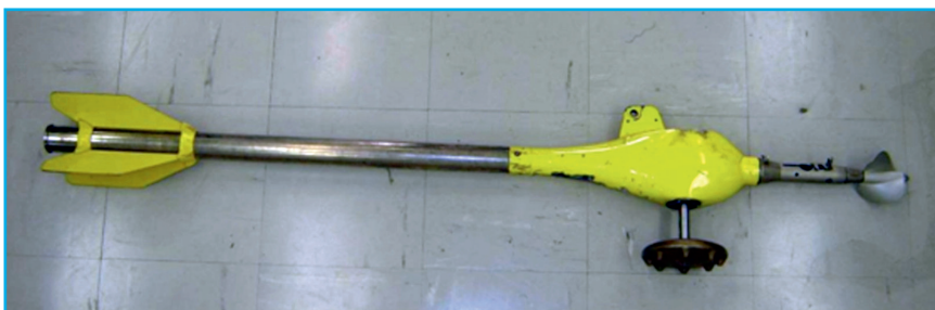
Figura 92. Molinete Hidrométrico (Foto: Luis Altivo Carvalho Alvim/CETESB).
