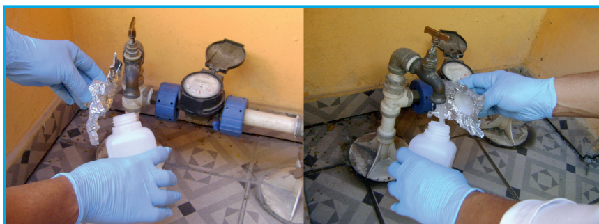
Figura 86. Coleta de amostra na torneira, após o hidrômetro (Foto: Venício Pedro Ribeiro/CETESB).
