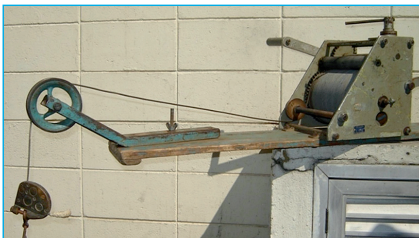
Figura 95. Guincho Hidrométrico (Foto: Luis Altivo Carvalho Alvim/CETESB).
