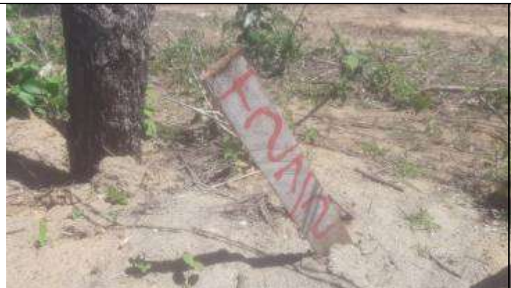
Figura 1. Marco central da torre 27-2.
