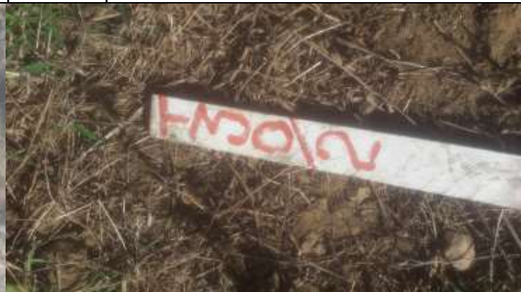
Figura 6. Marco central da torre 30-2.
