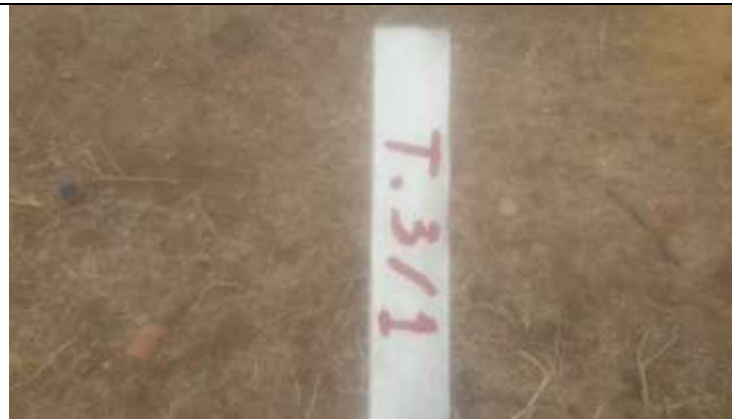
Figura 1. Marco central da torre 3-1.
